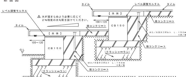
1. ステップ本体の底面に埋設されたインサート(4箇所)に付属のアンカーボルトをしっかりと締め付けます。(4本)
