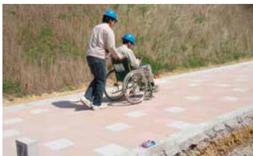
車椅子の前輪に付けた加速度計で振動を測定する
